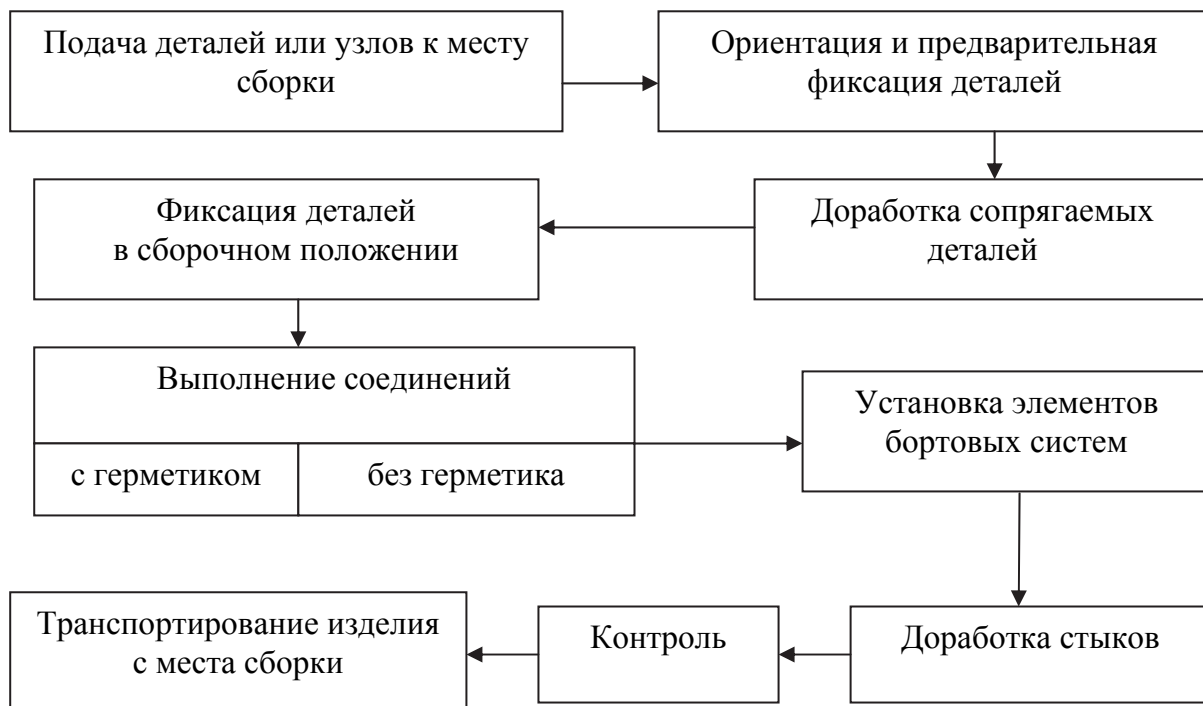
Рис. 4.2. Этапы сборки узлов и агрегатов
