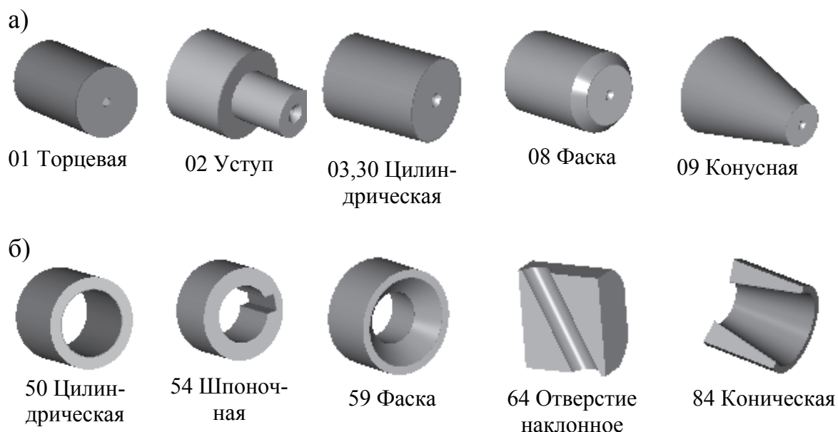
Рис. 4.8. Эскизы наружных (а) и внутренних (б) поверхностей деталей
