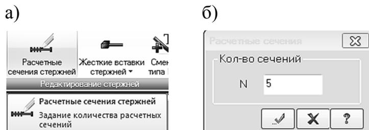
Рис. 2.41. Задание дополнительных расчетных сечений КЭ:
