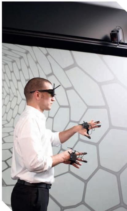
Для систем виртуальной реальности необходима информация о месте нахождения пользователя и его ориентации, чтобы «погрузить» его или ее в виртуальный мир. Система трекинга и датчики выдают такую информацию о пользователе, входных устройствах ввода и элементах модели (сидения, инструменты, приборы) по 6 координатам (6DOF). На сегодня оптические системы трекинга просты в эксплуатации и требуют минимального техобслуживания. Система IC.IDO поддерживает различные системы трекинга.
