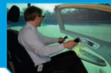
Стереоскопические системы визуализации с проекцией на несколько экранов для создания полного эффекта присутствия для оценки эргономики и интерьера автомобиля
