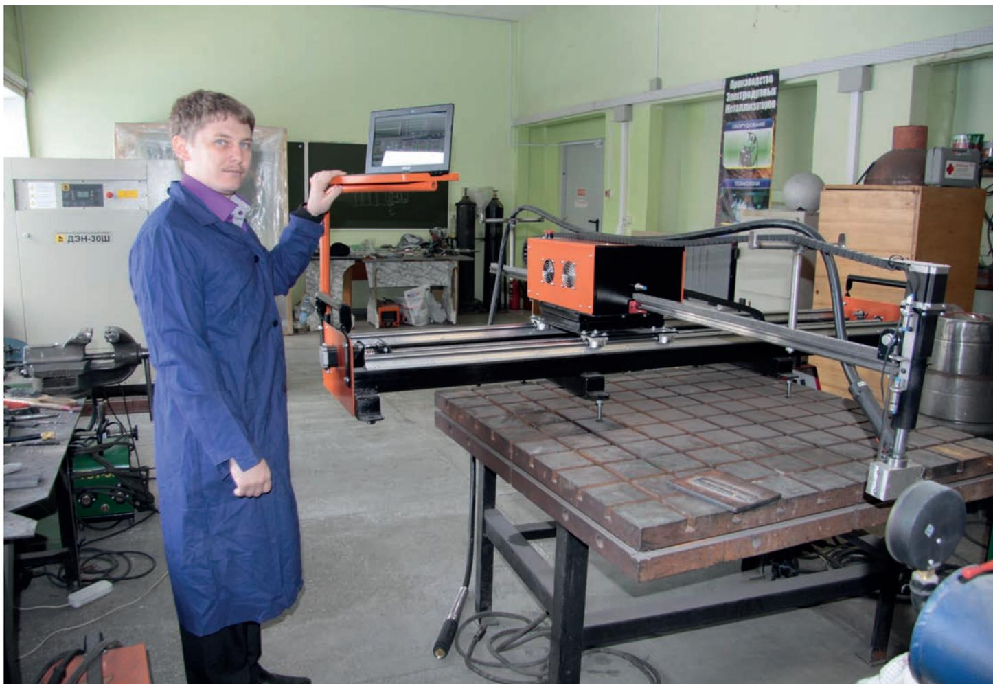
Установка может применяться в автомобильной, судостроительной, нефтехимической отраслях промышленности, на производствах по изготовлению бойлеров и сосудов высокого давления, машиностроительного оборудования и оборудования лёгкой промышленности, а также её можно использовать для раскроя и вырезки деталей из углеродистой стали, нержавеющей стали, алюминия, меди и других металлов в единичном и массовом производстве.
