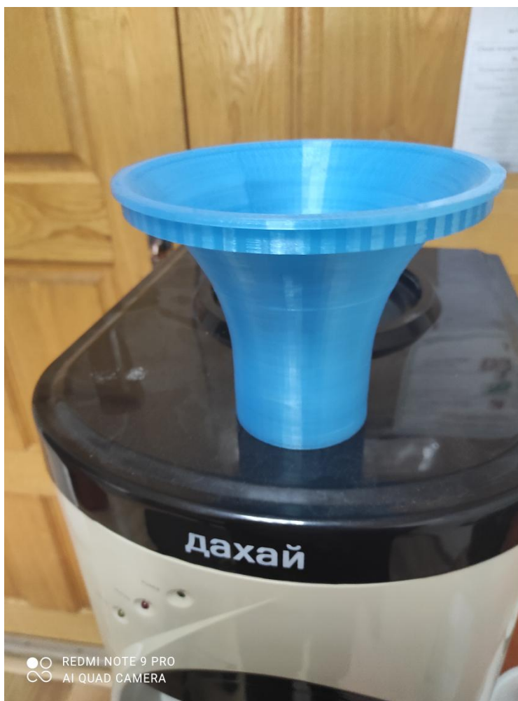
Рисунок 2.6 – Распечатанная, доработанная 3D-модель заливочной воронки диспенсера
