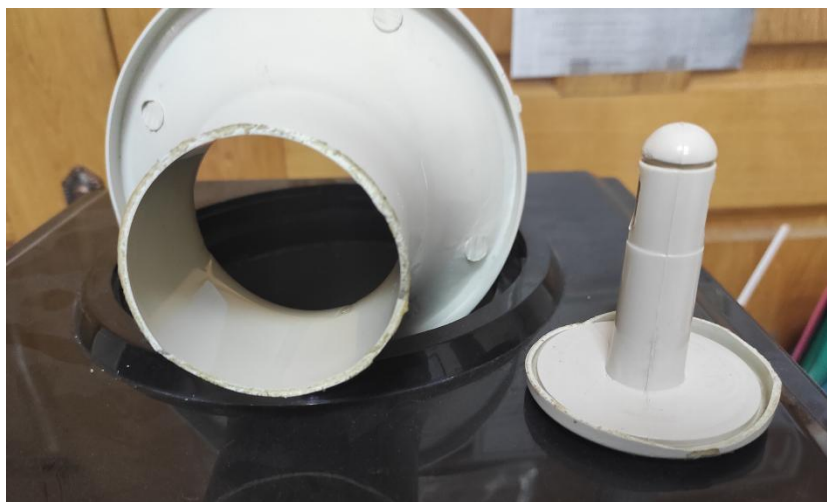
Рисунок 1.4 - Сломанная заливочная воронка
