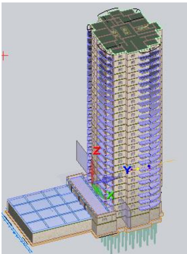
Рисунок 2.2 – Модель с заданными заграждениями в ПК САПФИР
