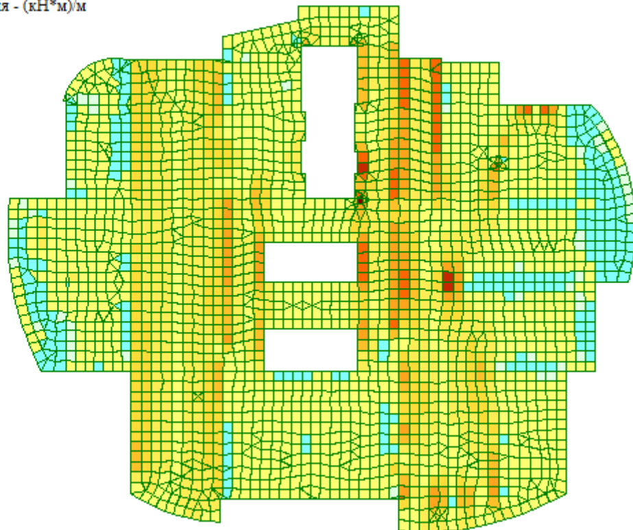
Рисунок 2.12 - Мозаика напряжений по M_x
