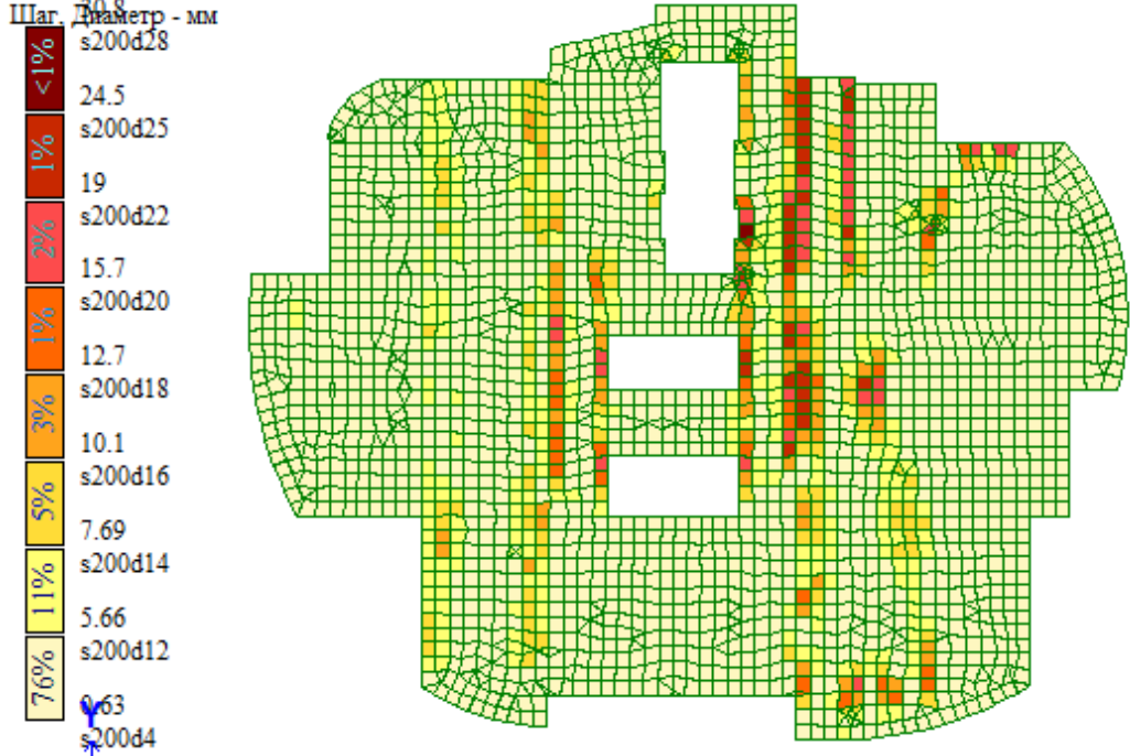
Рисунок 2.47 - Схема армирования низа плит по оси ОХ
