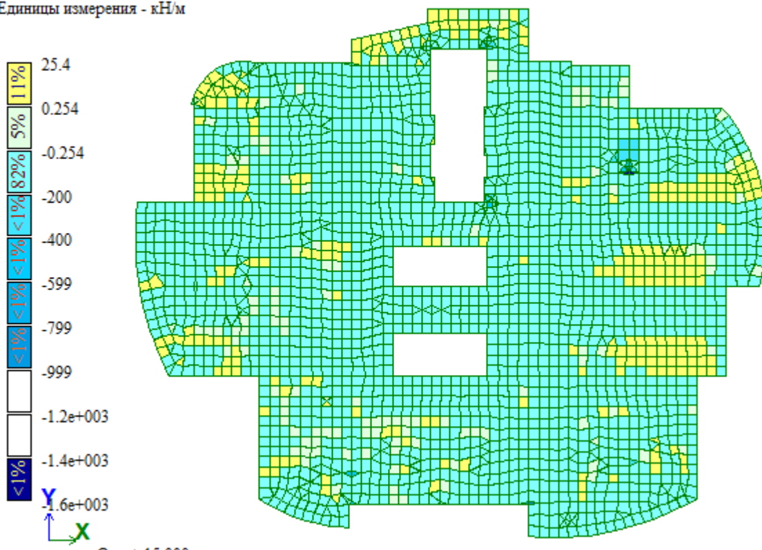
Рисунок 2.24 - Мозаика напряжений по Qy
