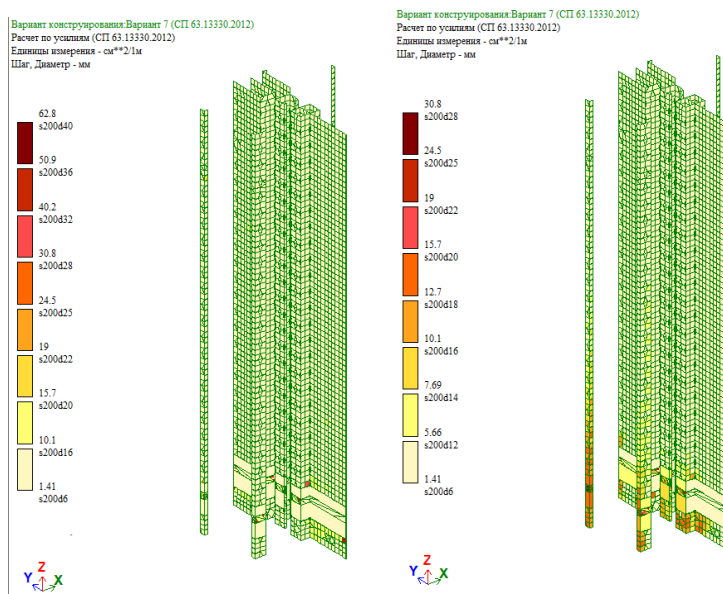
Рисунок 2.54 - Схема армирования низа стен по оси OX, OY (параллельно буквенным осям)
