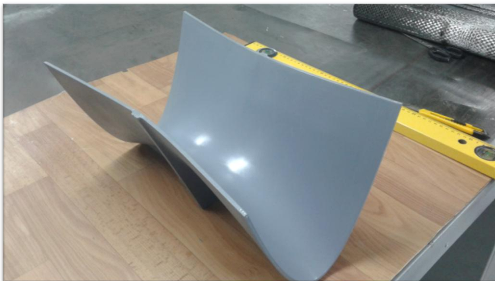
Рисунок 4 – Форма для свободной выкладки, напечатанная на 3Д-принтере
