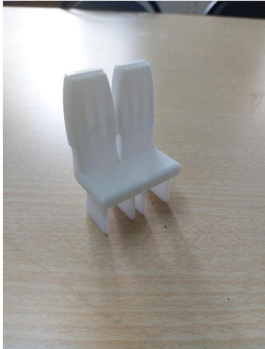
Рисунок 15 – Напечатанная на 3д принтере модель пассажирских кресел
