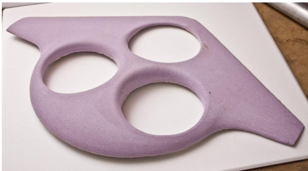
Рисунок 7 – Готовая основа болванки после ручной доработки
