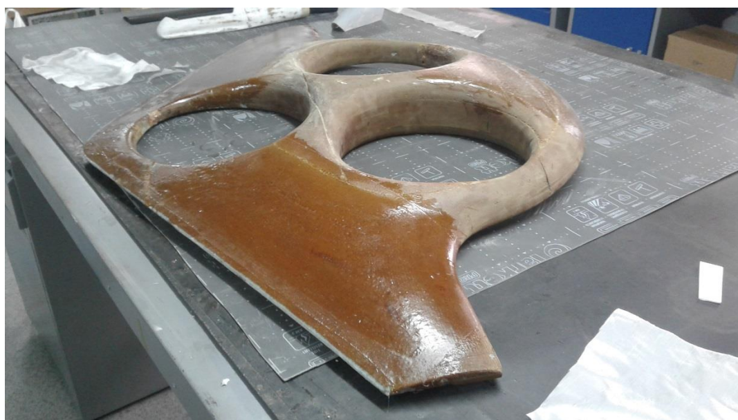
Рисунок 8 – Оклеивка поверхности стеклотканью
