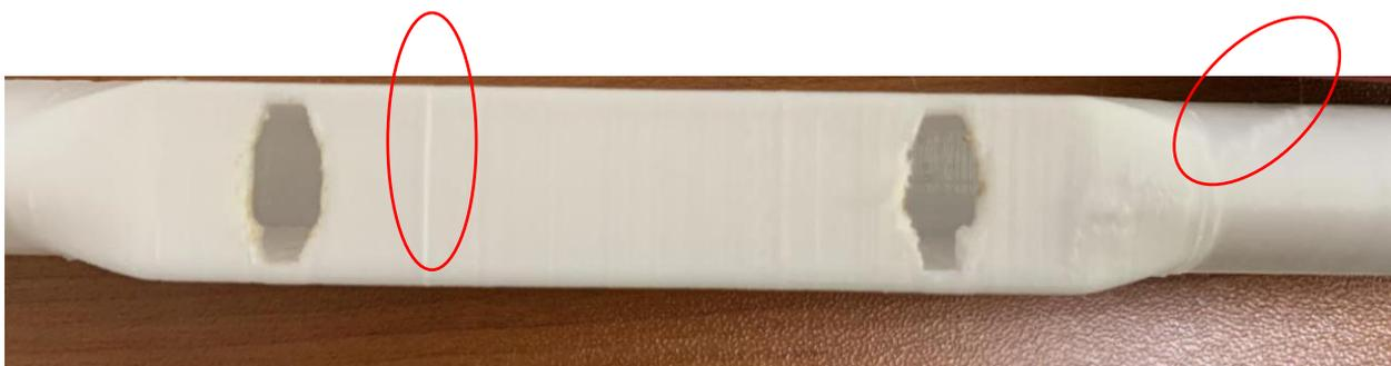
Рисунок 7 - Фотография рельефной части на поверхности детали
