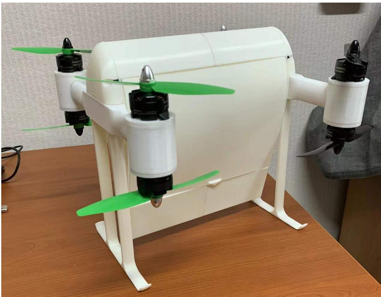
Рисунок 4 – Общий вид макета грузового БПЛА
