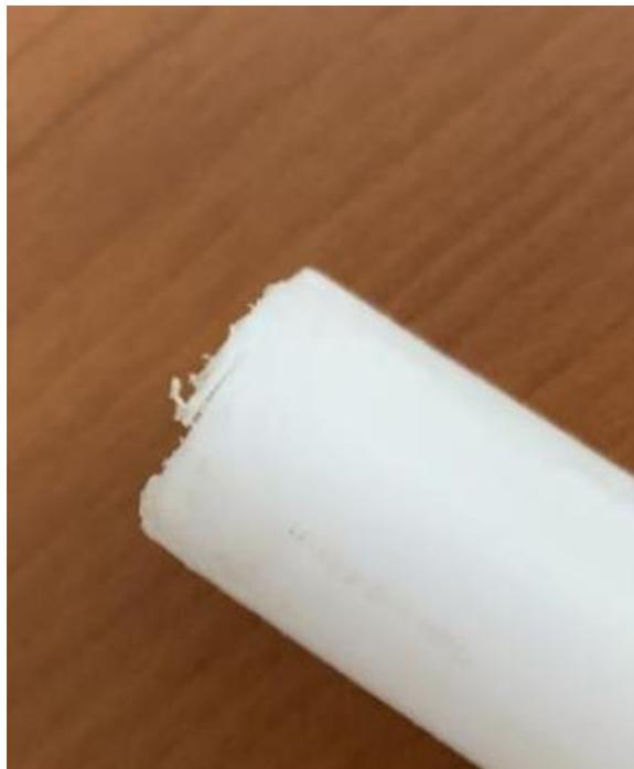
Рисунок 9 – Растрескивание в процессе доработки детали
