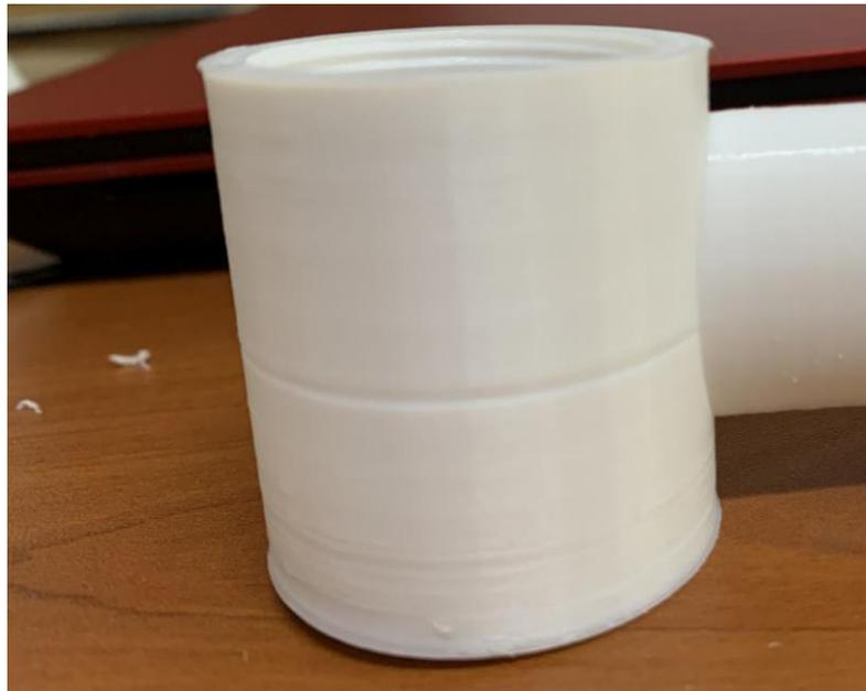
Рисунок 8 – Расслоение детали
