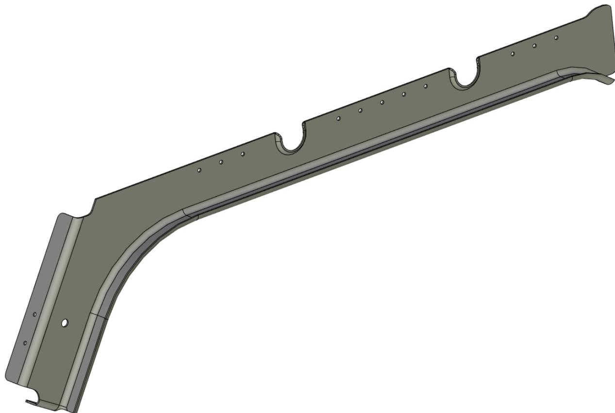
Рисунок 1.1 - Электронная модель элемента шпангоута
