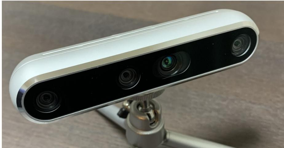
Рисунок А.1 – Камера RealSense D455
