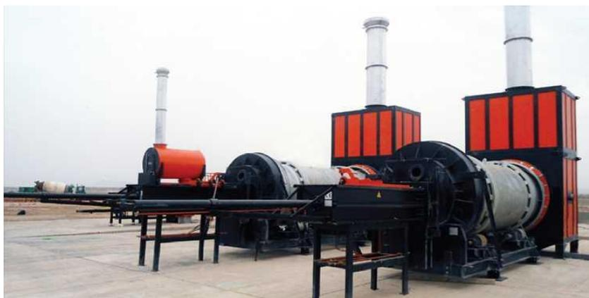
Рисунок 5 – Печь для сжигания отходов
