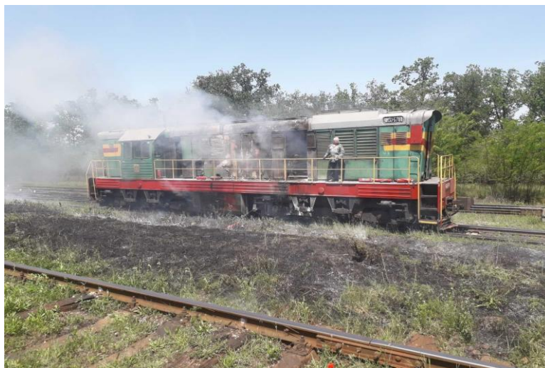
Рисунок 9 – Возгорание ТПС в недостигаемой зоне
