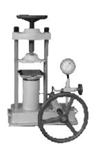
Предельная нагрузка 50 kN
