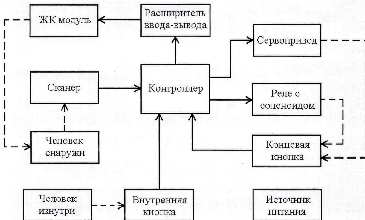
Рисунок 2 – Структурная схема изделия
