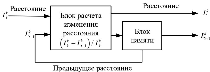
Рисунок 8 – Блок расчета изменения расстояния
