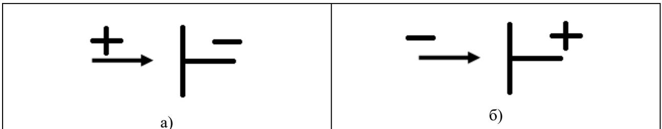
Сопоставить пробивные напряжения рис. (а и б) и объяснить различия.
