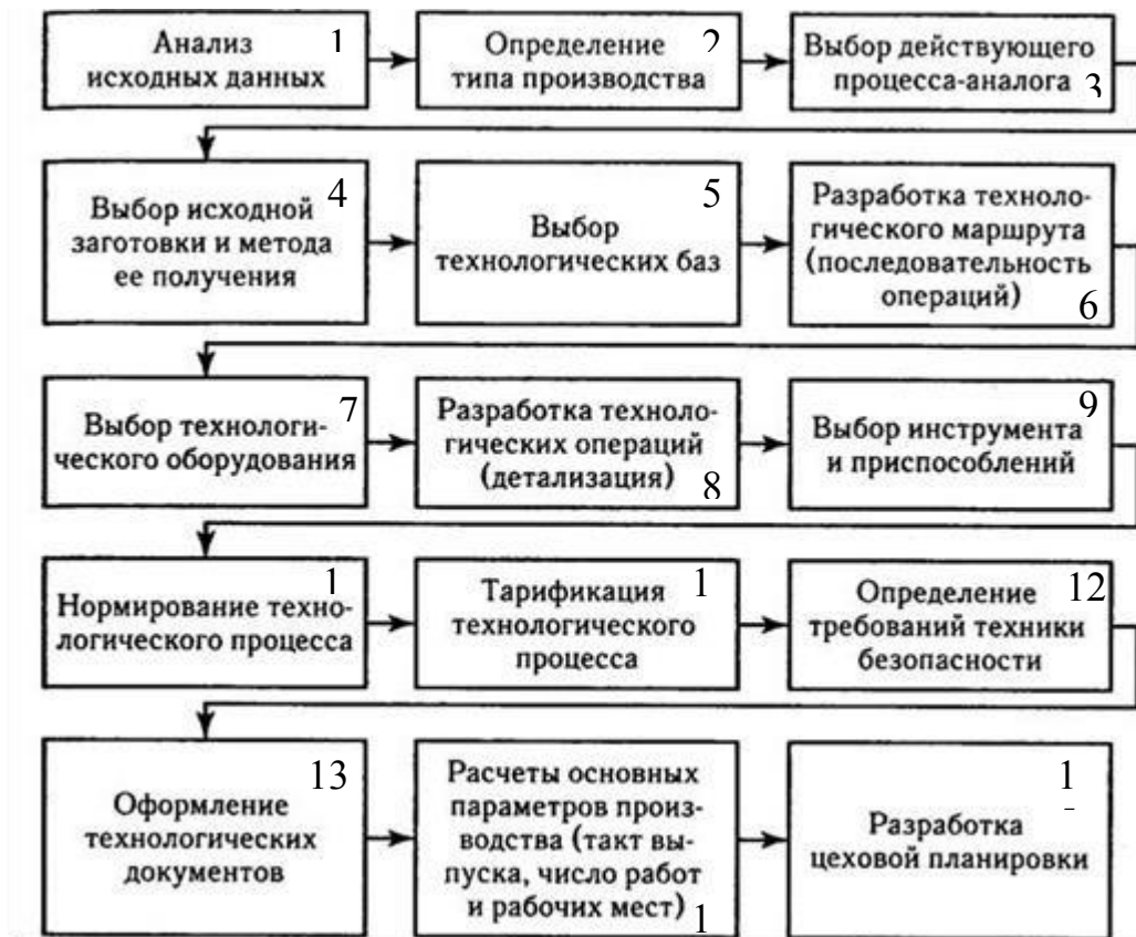
Рисунок 2 – Общая схема последовательности разработки технологического процесса
