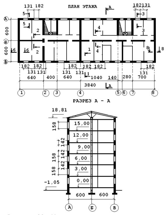
Высота этажа 2,8 м. Междуэтажное перекрытие выполнено из крупноразмерного железобетонного настила с круглыми пустотами. Вес 1 м2 настила 2,8 кН. Межкомнатные перегородки сборные гипсобетонные толщиной 8 см, межквартирные — гипсобетонные толщиной 16 см. Балконы из сборных железобетонных плит, закладываемых при монтаже блоков, запроектированы, начиная с третьего этажа. Вес балконной плиты 9,2 кН.
