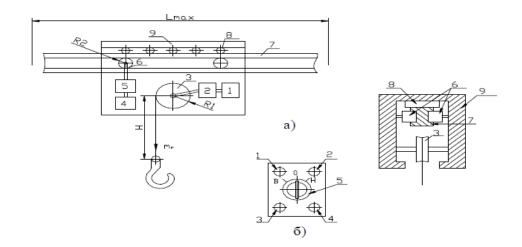
Рис.2.1. Конструктивная схема электротельфера (а) и пульта управления (б) 1,4—электромоторы; 2,5—редукторы; 3,6—шкивы подъема и перемещения; 7—несущая балка; 8— направляющие качения; 9—корпус. Пульт управления: 1,2—кнопки «Вкл.», «Откл.»; 3,4—кнопки «Подъем», «Опускание груза»; 5—переключатель перемещения тельфера
