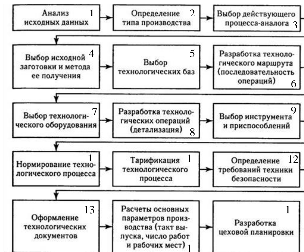
Рисунок 2 – Общая схема последовательности разработки технологического процесса
