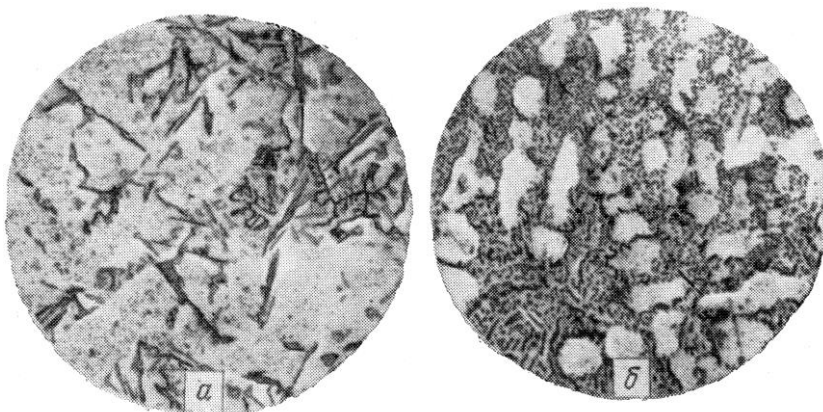
Рис. 6. Силумин, X200: а – после литья без применения специальных добавок в жидкий металл, б – после литья с применением специальных добавок
