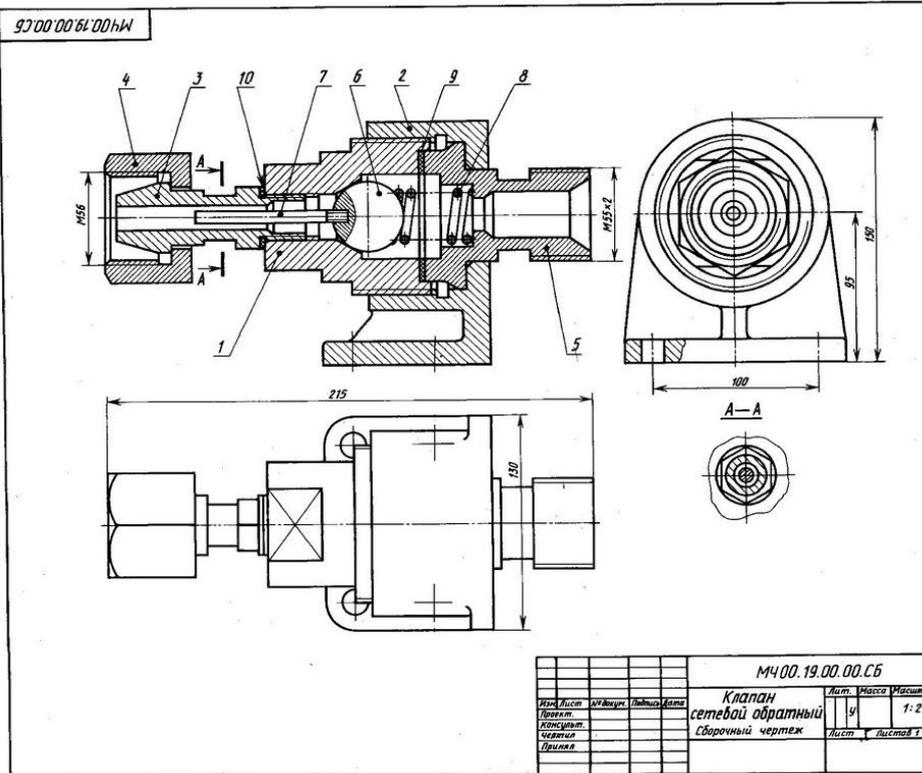
Обратный сетевой клапан предназначен для предотвращения газопроводной сети с горючим газом от случайного попадания в нее воздуха. При падении давления клапан перекрывает газопровод, исключая возможность обратного тока газа (от потребителя) и предотвращая образование в газопроводе взрывоопасной газокислородной смеси.
