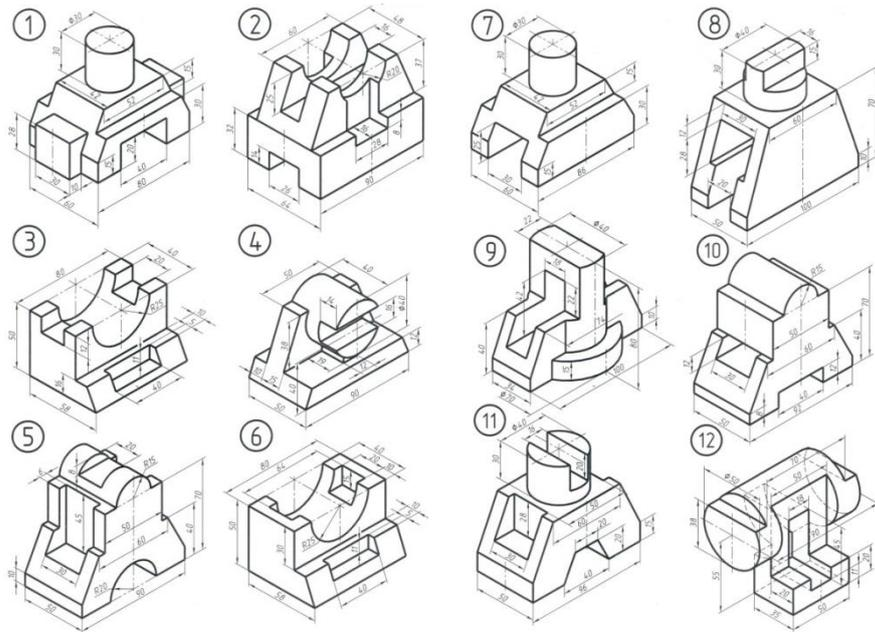
Рисунок 2 – Некоторые варианты деталей для моделирования по аксонометрическому чертежу.
