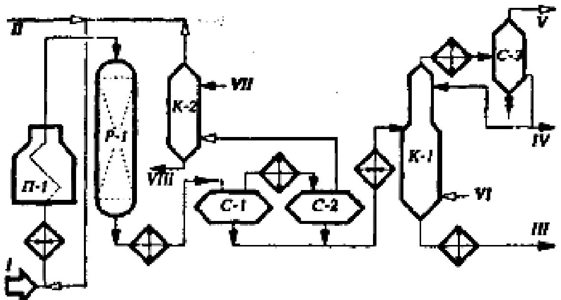
2000: I – сырье; II – свежий ВСГ; III – гидрогенизат; IV – бензин; V – углеводородный газ на очистку; VI – отдувочный ВСГ; VII – регенерированный МЭА; VIII – раствор МЭА на регенерацию
