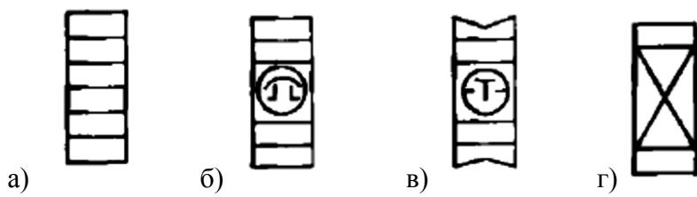
4. Каким образом на схеме обозначается проходной предохранительный клапан
