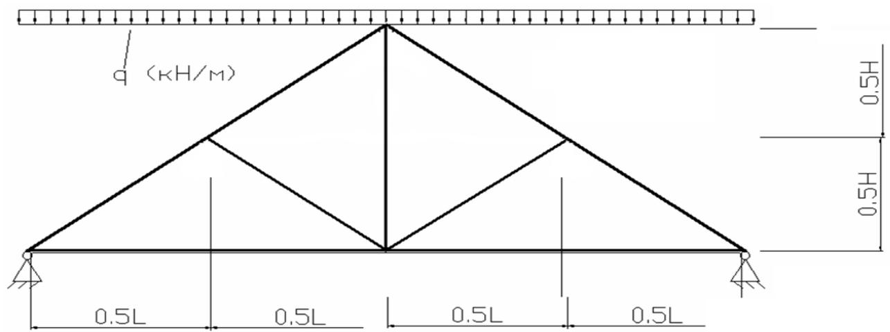
Рисунок 1. Расчетная схема металлодеревянной фермы.
